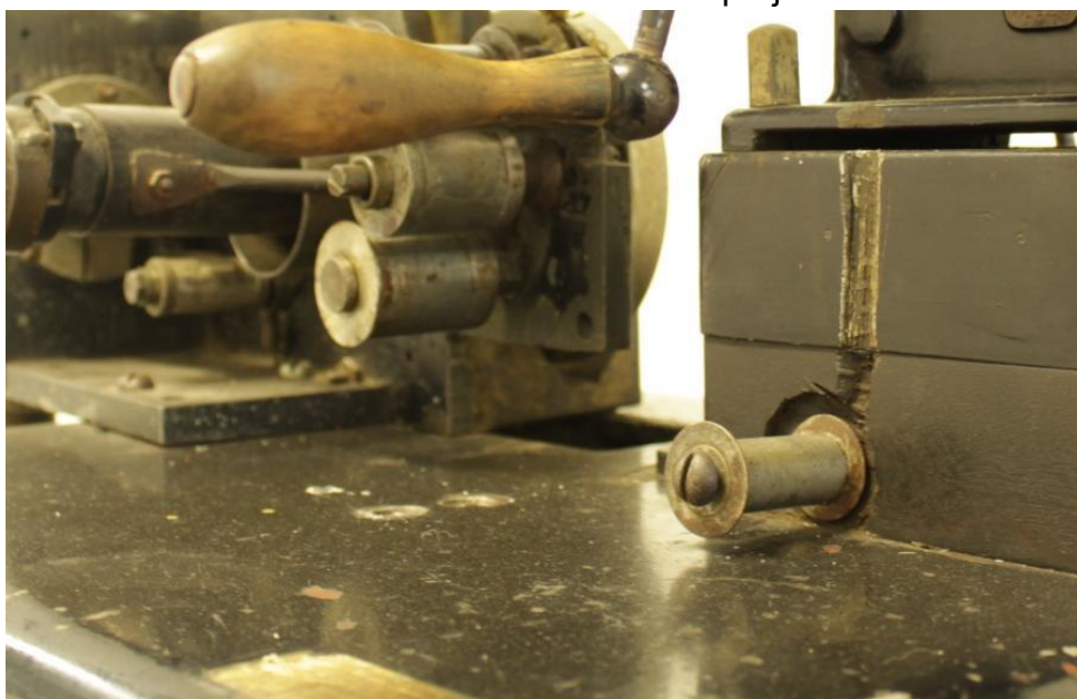
Figura 16 - Detalhe das marcas de porca (dois buracos na base) e caminho entalhado na madeira acima do trilho no projetor de Bonfioli
