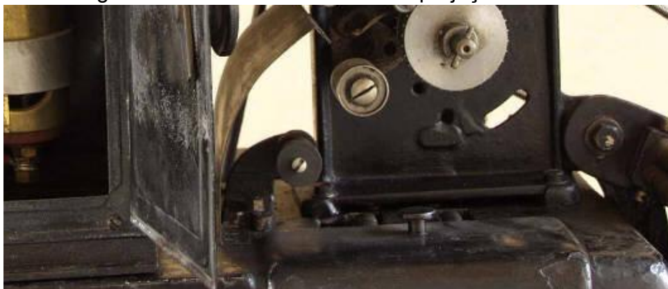
Figura 15 -. Detalhe dos trilhos de projeção do Balilla
