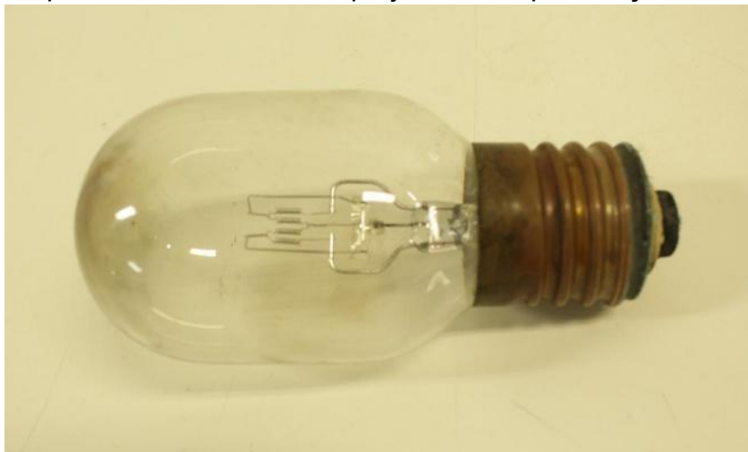
Figura 9 - Lâmpada incandescente do projetor, as especificações se desgastaram
