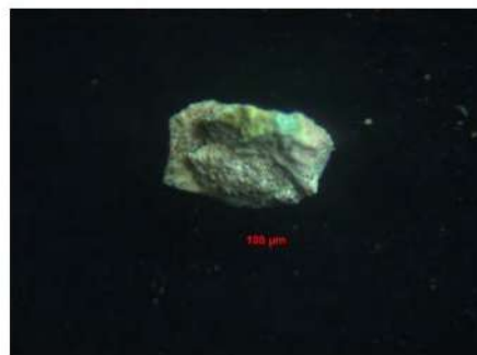
Figura 5-Amostra 4596T-Verso do fragmento usado para corte estratigráfico. Visto sob o microscópio estereoscópico-aumento 40x
