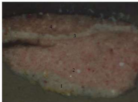
Figura 6- Amostra 4596T-Corte estratigráfico. Visto sob o microscópio de luz polarizada-aumento 16.5X
