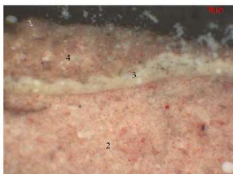
Figura 7- Amostra 4596T- Corte estratigráfico.Visto sob o microscópio de luz polarizada -aumento 33x_área_superior
