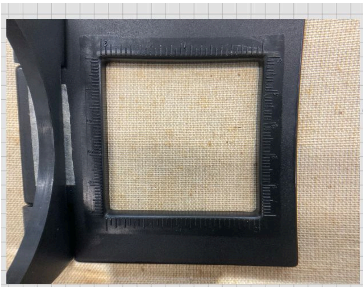
Figura 4: Contagem de fios do tecido da tela.
