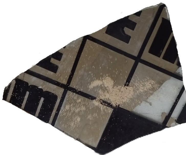
Figura 50 - Alteração visual esbranquiçada
