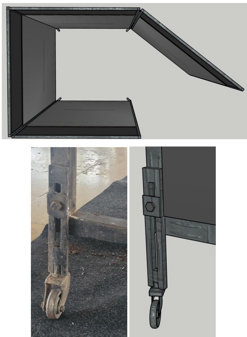
Figuras 37, 38 e 39 - Visão Panorâmica da abertura da porta e Roda de sustentação: original e modelo 3D, respectivamente.
