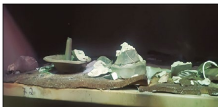
FIGURA 102 – Peças fraturadas aderidas às prateleiras de aço das estantes.
