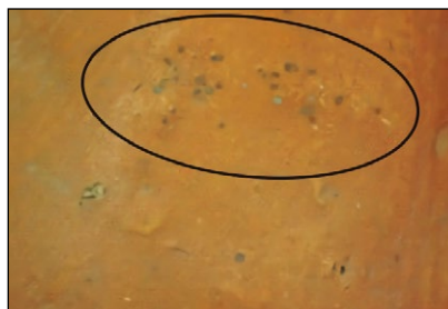
FIGURA 63 - Grânulos pétreos na peça Moringa com tampa, MHNJB-UFMG, detalhe. Fonte: AGE Almada, 2013.
