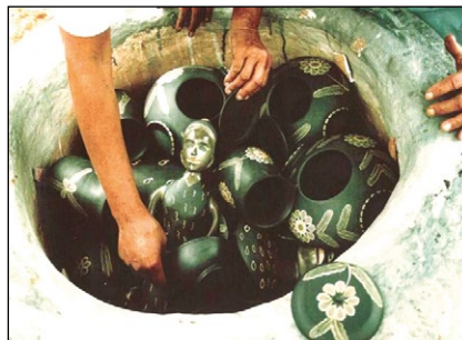
FIGURA 20 – Montagem do forno para a queima, Campo Alegre, Turmalina, Minas Gerais.
