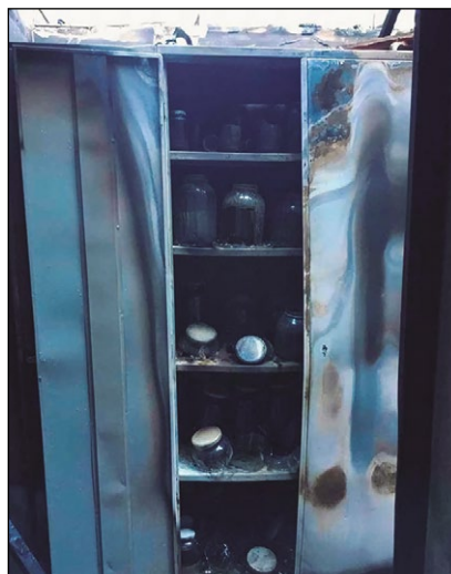
FIGURA 96 – Mobiliário em aço da Sala C, com acervo da zoologia destruído pelo incêndio.
